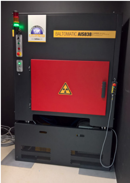
Fig. 2. Le cabinet de radiographie Grenz du Rijksmuseum (Balteau NDT Baltomatic AIS838). Cette unité peut accueillir des objets jusqu'au format raisin (60 × 80 cm). © Rijksmuseum.
