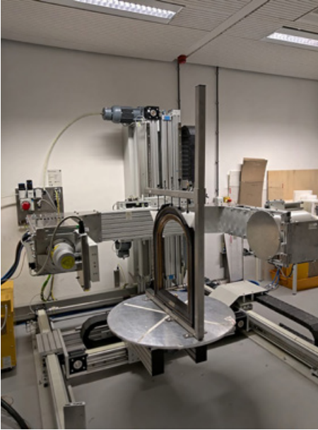
Fig. 3. Salle de radiographie du Rijksmuseum, pour les équipements générant des rayons X de haute énergie (jusqu'à 225 kV). Sur cette image, équipement Baltograph, par Balteau NDT (15-225 kV), utilisé pour les matériaux lourds. © Rijksmuseum.
