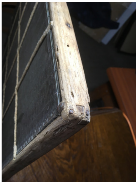
Fig. 2. Détail d'une forme. Le plan filtrant vergé et son support également vergé sont montés « à la française » sur le châssis. Le fil d'eau constitué d'une grosse ficelle est cloué sur le châssis et cousu sur le plan filtrant. Un feillard vient sertir l'extrémité du plan filtrant, laissant un léger espace entre ce dernier et le châssis. © N. Dumain
