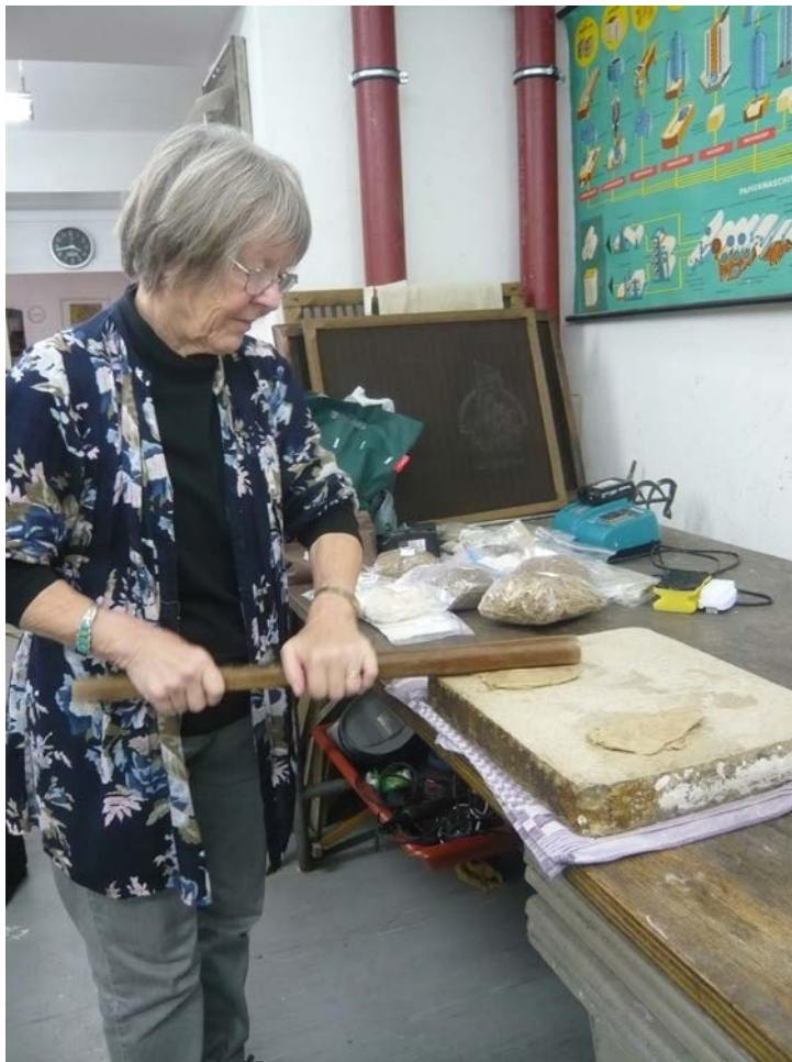
Fig. 2. Reproduction de battage manuel des fibres © C. Laroque
